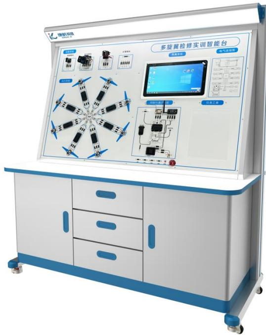
图3 多旋翼检修智能台
